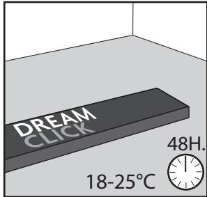
DreamClick Pro-Bodenbeläge sollten vor dem Verlegen 48 Stunden horizontal in dem Raum gelagert werden, in dem der Boden auch verlegt werden soll in der ungeöffneten Verpackung. Die idealen Innenraumklimabedingungen liegen zwischen 18 und 25 °C. Halten Sie die Temperatur während der gesamten Montage konstant.
