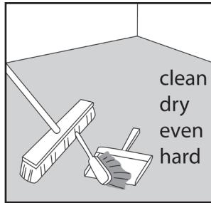
Die Arbeitsfläche muss sauber und frei von Bauabfällen sein, die den Bodenbelag beschädigen könnten. Unebenheiten im Unterboden können sich auf die zu verlegenden Bodenelemente übertragen. Dies kann zu unansehnlichen Oberflächen und höherem Verschleiß an höher gelegenen Stellen und/oder Vertiefungen an den tiefer gelegenen Stellen führen. Der Arbeitsbereich ist zu reinigen und von allen Ablagerungen, die den Boden beschädigen könnten, zu säubern.
