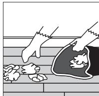
Eine trockene Reinigung zur Beseitigung von losem Schmutz, Schutt, Belagresten etc. durch Kehren bzw. Saugen.
