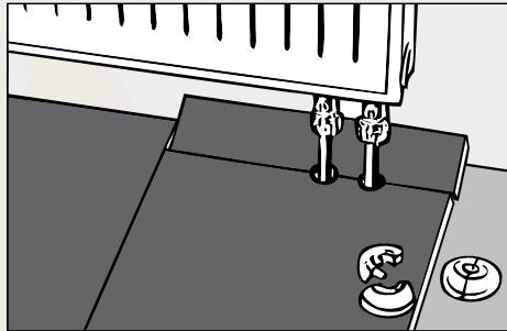
**5** Bei Heizungsrohrdurchbrüchen die Dièle am Stoß aussinken und mit Heizkörperrosetten abdecken.
