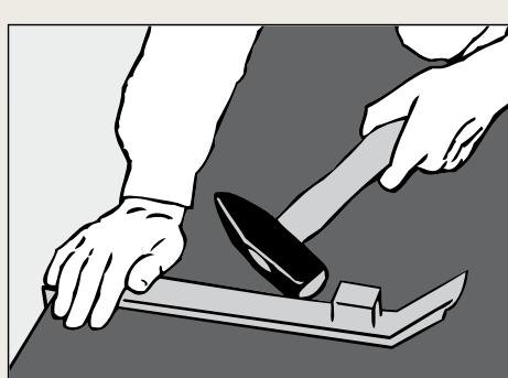
**8** Die letzte Dielenreihe wird mit dem Zugeisen längsseitig und mit dem Schlagklotz stirnseitig zusammengetrieben.
