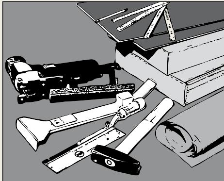
**1** Alles bereit? Als Werkzeug benötigen Sie: Zollstock, Bleistift, Stichsäge (Sägeblatt MPS 3125 oder Bosch T 141 HM), Fuchsschwanz, Kreissäge, Fäustel, Setzlatte, ZIRO Schlagklotz, Zugeisen.
