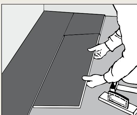
**4** Nachdem die erste Reihe mittels einer Setzlatte exakt ausgerichtet wurde, beginnen Sie mit dem Reststück der letzten Dièle der ersten Reihe die Verlegung der zweiten Reihe. Die Stirnstoße (Querfugen) der Dielen von Reihe zu Reihe müssen jedoch mind. um 15 cm versetzt sein.
