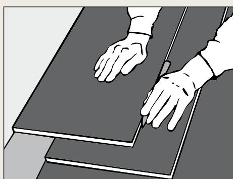
**7** Einpassen der letzten Dielenreihe: Legen Sie exakt auf die zuletzt verlegte Dielenreihe die nachzusägende Dièle. Dann zeichnen Sie mit Hilfe einer weiteren Dièle den Längsschnitt an. Durch diese Art des Anzeichnens bleibt genügend Abstand zur Wand um die letzte Reihe mittels Zugeisen einzuzwickeln.
