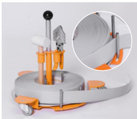
Einfach die Rolle der Weichsockelleiste in den Easy-Scooter einlegen und den Anfang der Weichsockelleiste zwischen die Führungsstifte legen.
