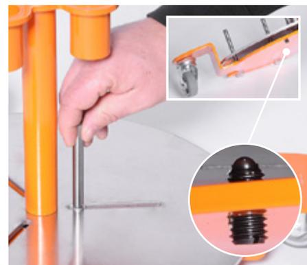
Die Führungs- und Haltestifte sind mühelos verstellbar. Nach Belieben kann durch Verstellen der Schraube an der Unterseite des Gerätes der Drehteller abgebremst werden.
