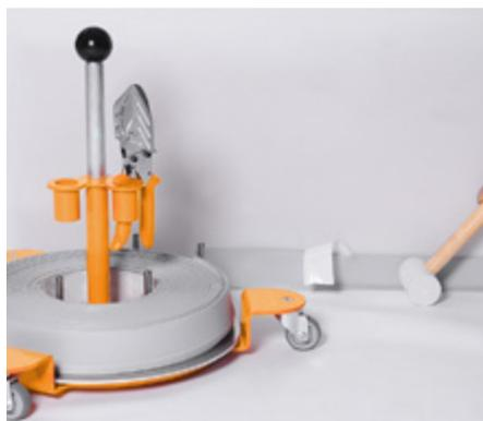
Bei der Montage wird die Weichsockelleiste gleichmäßig vom Easy-Scooter abgerollt. Das Schutzpapier des Klebandes wird entfernt und das Profil an die Wand geklebt. Danach ist ein lückenloses Anschlagen mittels des Döllken Montagehammers erforderlich.
