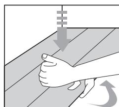
Falls Sie den Boden entfernen möchten, heben Sie die Dielen einigem Zentimeter nach oben an und klopfen Sie an der Verbundleiste entlang. Die gelöste Dielle kann dann ganz einfach herausgezogen werden.
