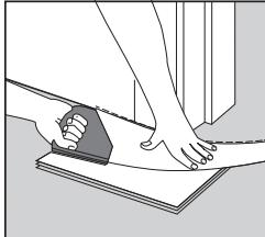
Falls ein Türrahmen gekürzt werden muss, verwenden Sie zu Ermittlung der richtigen Höhe ein Stück Dielle. Sägen Sie die Türrahmen und Zargen auf die richtige Höhe zurecht. Lassen Sie zwischen dem Bodenbelag und dem Türrahmen einen Spalt von 2mm. In diesen Fällen können die Dielen falls erforderlich von allen Richtungen aus verlegt werden. Dadurch wird es leichter, die Verlegung von Dielen z. B. an Türen zu planen.
