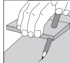
Manchmal muss die erste Reihe zugeschnitten werden, um die Unebenheit einer Wand auszugleichen. Transfer the shape of the wall to the planks. Übertragen Sie die Kontur der Wand auf die Dielen. Halten Sie einen Abstand von 5mm zur Wand für die Dehnungsfuge ein.
