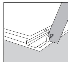
Falls es Ihnen nicht gelingt, die Dielle im richtigen Winkel am Türrahmen oder einem tief gehenden Heizkörper zu verlegen, können Sie wie auf der Abbildung gezeigt. Schneiden Sie einfach die Schließkante ab. Klebstoff (PVA-Klebstoff, Klasse D3) Verlegen Sie die Dielle.
