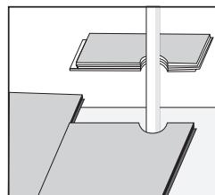
Bohren Sie in die Dielen die erforderlichen Aussparungen. Falls die Rohre durch den Boden verlaufen, schneiden Sie eine Öffnung aus der Dielle heraus, die mindestens 10mm größer als der Durchmesser des Rohrs sein sollte.
