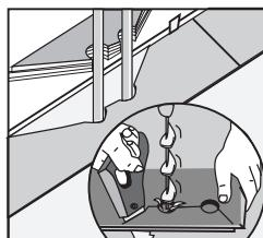
Schneiden Sie die Dielle im 45o-Winkel zur Öffnung ab. Das ausgeschnittene Stück wird dann wieder in die Position geklebt. Bedecken Sie die Öffnung mit einer Rohrhülse.
